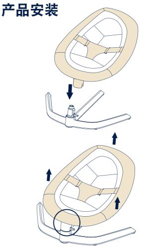
将座椅转轴对准底座转轴卡合,听到"喀"声表示组装完成。
